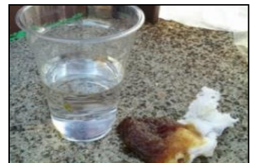
3、スーパーオイルグリッパーを引き上げ 処理完了(白い所はまだ吸着が可能)
